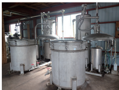
ひと釜100kgの葉を、約90分蒸留させると約300ccの精油が抽出される
